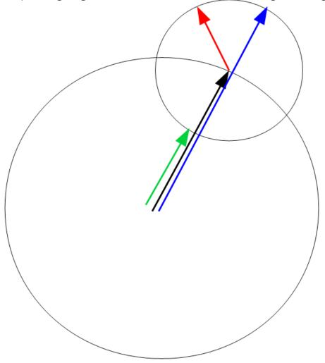
Abbildung 1: Überlagerung von Spannungen mit verschiedener Phase
